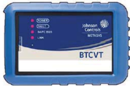
图9: 无线调试转换器
